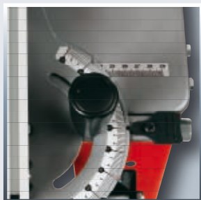
Prowadnica ze skalą kątową
