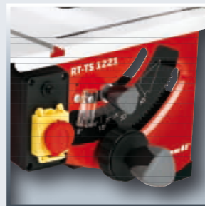
Regulacja tarczy (wysokość, nachylenie)
