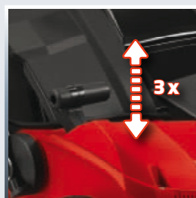
Regulacja głębokości roboczej
