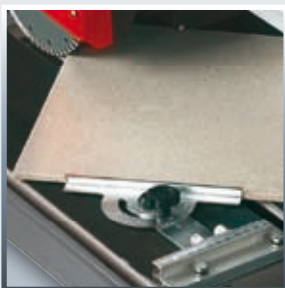
Precyzyjnie ustawiana prowadnica kątowa
